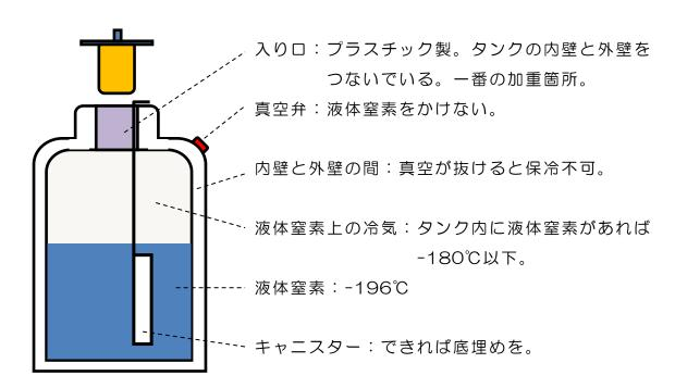
タンクはステンレス製の内壁と外壁の間が真空になっており、真空が抜けると 冷気を保つことができなくなります。タンクには構造的に弱い箇所が二つあります。一つ目はタンクの入り口です。ここは筒状のプラスチック製で内壁と外壁を つないでおり、内壁部分がタンクの入り口からぶら下がったような感じになって います。したがって、液体窒素が貯まった状態でタンクを激しく揺らしたり、大きく傾けたりすると入り口部分に過大な加重がかかり、プラスチックやつなぎ目 が割れ、真空が抜ける恐れもあるため注意が必要です。もう一つの弱い箇所が真空弁です。真空弁は入り口の近くにある 2~3cm ほどの突起で、タンクを製造する際に内壁と外壁の間の真空引きをする部分です。ここには金属製の球が埋め込まれており、タンクの真空を保っています(ラムネのビー玉のイメージ)。ここに
